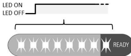
Abbildung 8: Statusanzeige zeigt Betriebsbereitschaft durch konstantes Leuchten aller acht LEDs an
